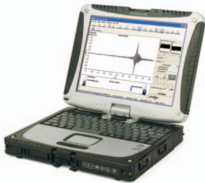
Рис.3. Четкий корреляционный пик в месте расположения утечки
